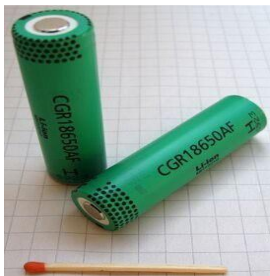
2.4-сурет – Литий-ионды аккумулятор цилиндрлі, 18650 өлшемді
